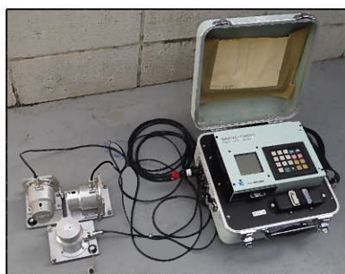
図3 長周期まで測定可能な常時微動計測器
