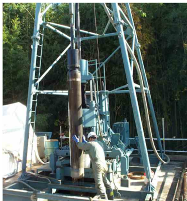
砂礫の採取（採取試料径 \phi 300mm）
