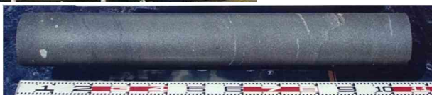
採取した砂礫試料（試料径 \phi 300mm）
