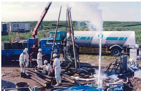
砂質土の採取（採取試料径 \phi 65mm）
