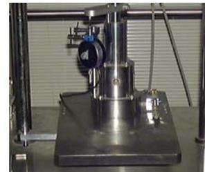
圧密試験（定ひずみ）
