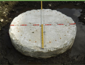
杭径測定状況
