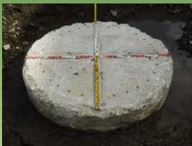
杭径測定状況
